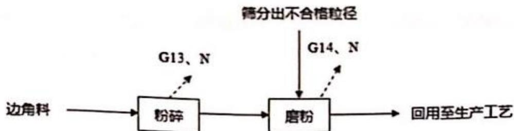
图 2-1 生产工艺流程及产污节点图
